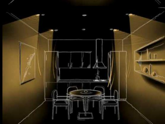
Освещение вертикальной поверхности (Wallwasher)
